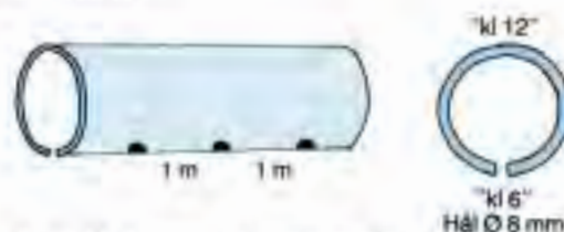
Figur 37. Exempel på spridningsledning vid pumpning (Obs ej skalenlig figur).
