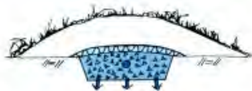
Figur 45. Exempel på utformning av grund infiltrationsanläggning.
