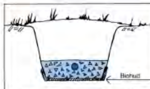
Figur 17. Principen för infiltration samt biohudens läge.
