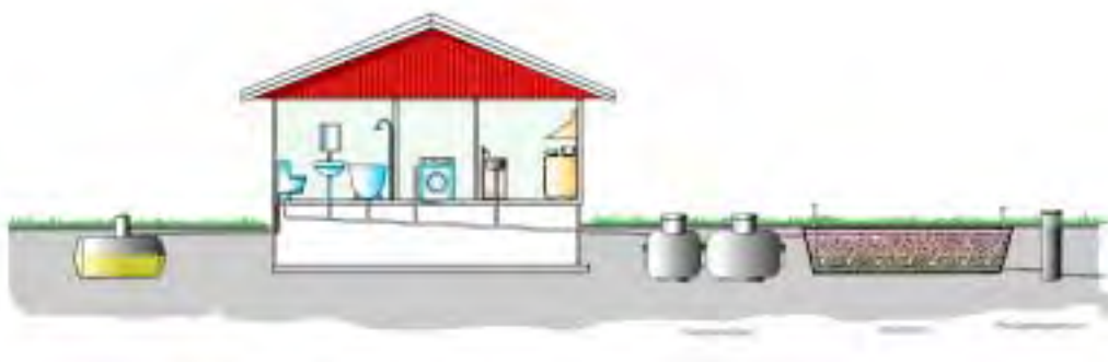
Figur 15. Principskiss för avloppsanläggning med urinsortering och behandling av urinavlastat avloppsvatten i markbädd.
