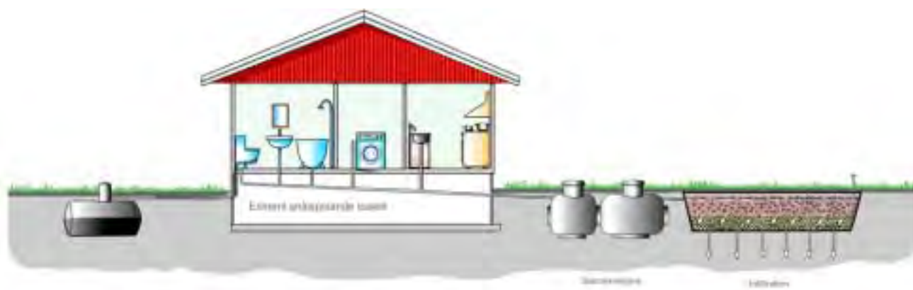
Figur 17. Principskiss för avloppsanläggning med sluten tank och rening av BDT-vatten genom infiltration.
